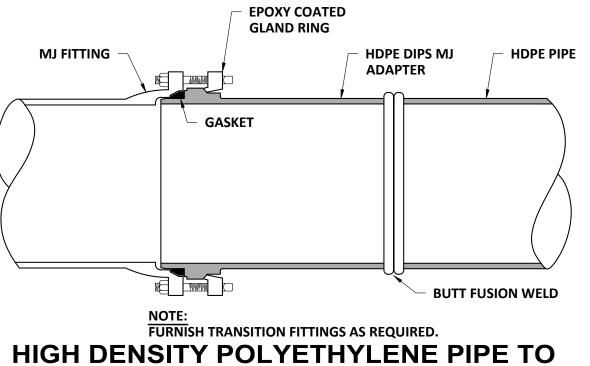
**MECHANICAL JOINT CONNECTION DETAIL**
